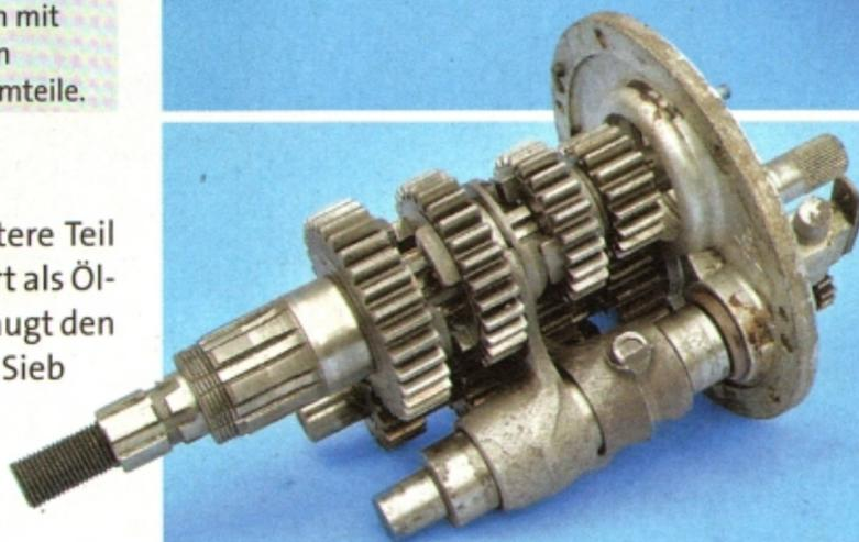
Die Getriebeausgangswelle ist eine kurze Hohlwelle, die sich auf dem rechten Ende der Eingangswelle dreht
