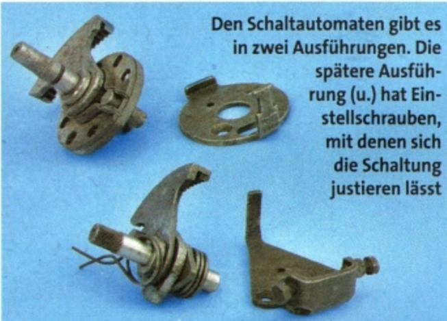
Den Schaltautomaten gibt es in zwei Ausführungen. Die spätere Ausführung (u.) hat Einstellschrauben, mit denen sich die Schaltung justieren lässt
