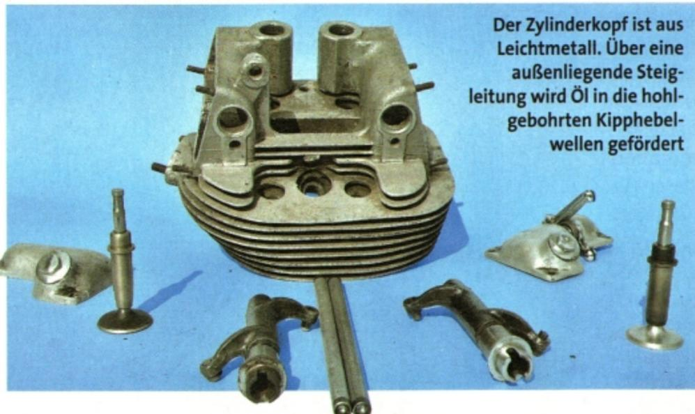
Der Zylinderkopf ist aus Leichtmetall. Über eine außenliegende Steigleitung wird Öl in die hohlgebohrten Kipphebelwellen gefördert
