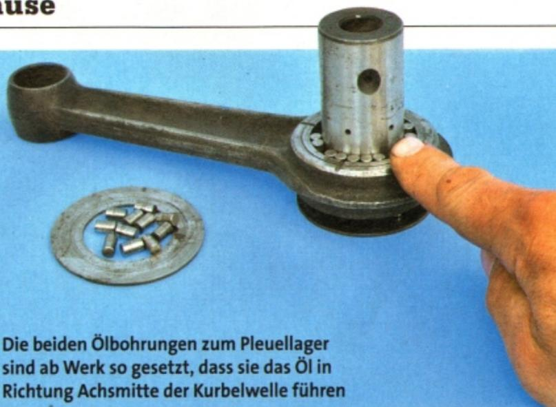
Die beiden Ölbohrungen zum Pleuellager sind ab Werk so gesetzt, dass sie das Öl in Richtung Achsmittle der Kurbelwelle führen
