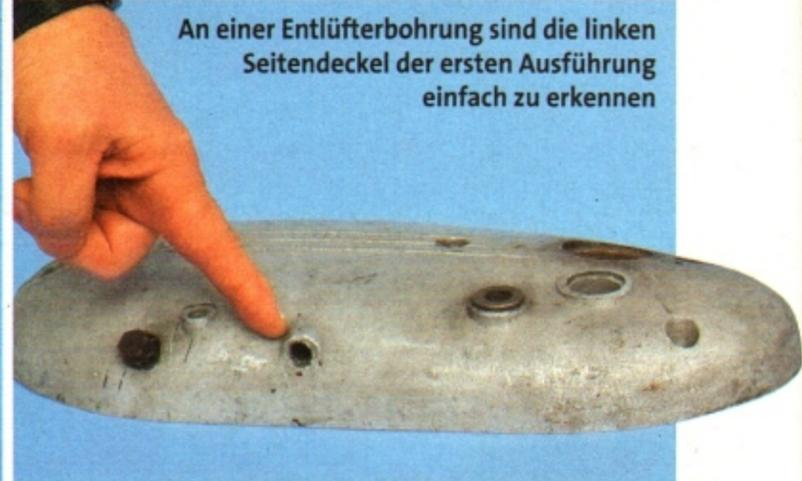
Das Zwischenrad fungiert auch als Drehschieber der Motorgehäuseentlüftung
