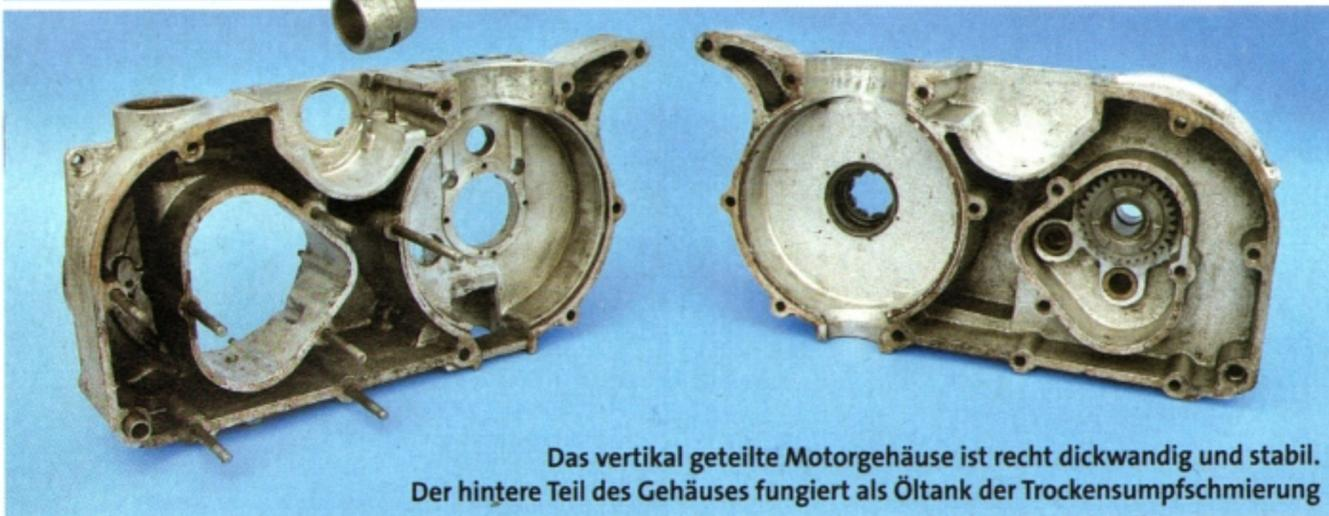
Das vertikal geteilte Motorgehäuse ist recht dickwandig und stabil. Der hintere Teil des Gehäuses fungiert als Öltank der Trockensumpfschmierung
