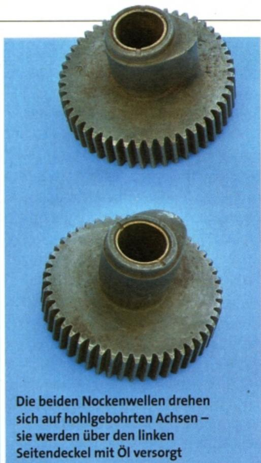
Die beiden Nockenwellen drehen sich auf hohlgebohrten Achsen – sie werden über den linken Seitendeckel mit Öl versorgt
