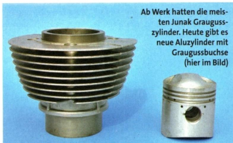
Ab Werk hatten die meisten Junak Graugusszylinder. Heute gibt es neue Aluzylinder mit Graugussbuchse (hier im Bild)
