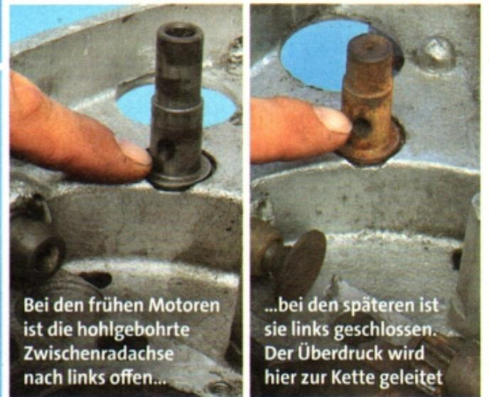
Bei den frühen Motoren ist die hohlgebohrte Zwischenradachse nach links offen...
