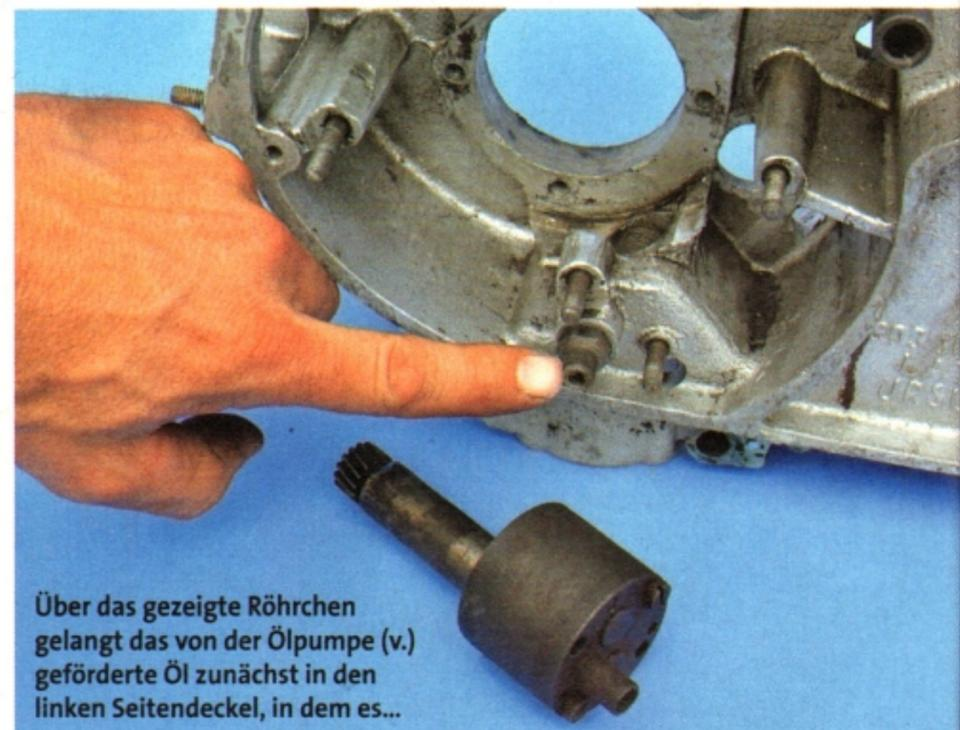
Über das gezeigte Röhrchen gelangt das von der Ölpumpe (v.) geförderte Öl zunächst in den linken Seitendeckel, in dem es...
