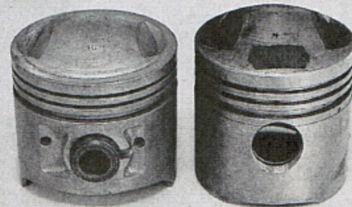
Ersatzkolben finden Junakisti im Fiat- oder Porsche-Teillager – oder samt Zylinder bei VW
