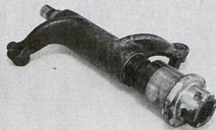
Exzentrisch gelagerte Kipphebelwellen machen die Ventileinstellung zum Kinderspiel
