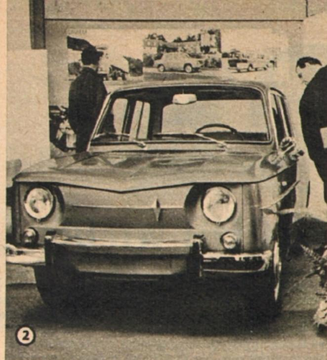
② Unter den von den französischen Renault-Werken in Leipzig vorgeführten Modellen war auch der R 8. Der wassergekühlte Vierzylinder-Viertakt-Heckmotor von 956 ccm ist 8,5 : 1 verdichtet und leistet 40 PS
