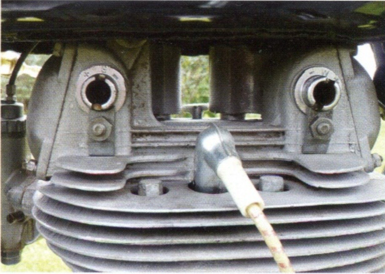
Junakissa on kätevä, ulkopuolinen venttiilivälysten säätö.
