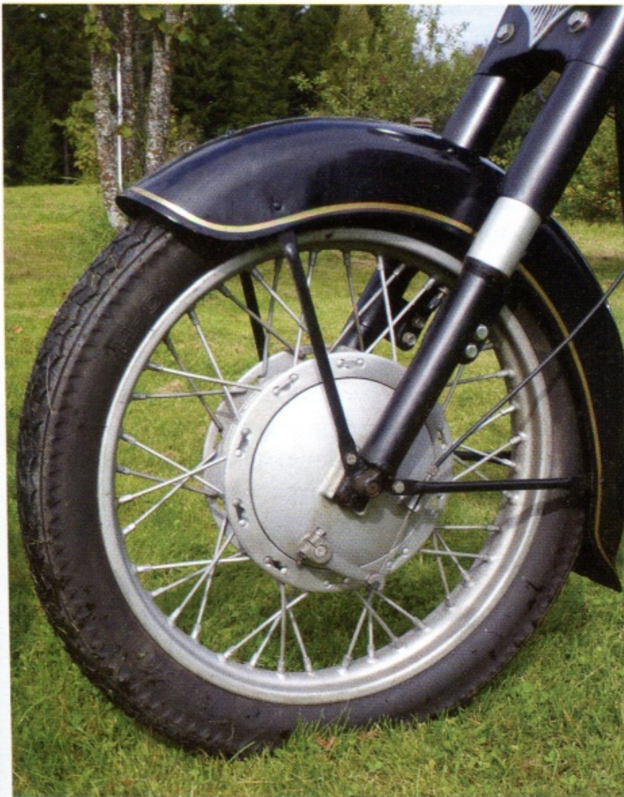
Junakissa on teleskooppihaarukka, jossa on öljyllä toimiva iskunvaimennus. Sekä alumiinisen jarrurummun että etulokasuojan pinta on karua työtä.
