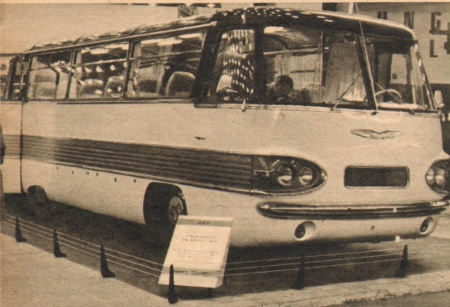
Der Ikarus 303 hat Luftfederung und bietet 27 bis 38 Personen Platz je nach Ausführung. Sein Heckmotor leistet 95 PS. In der Formgebung ist er der schönste Bus, der in Leipzig zu sehen war
