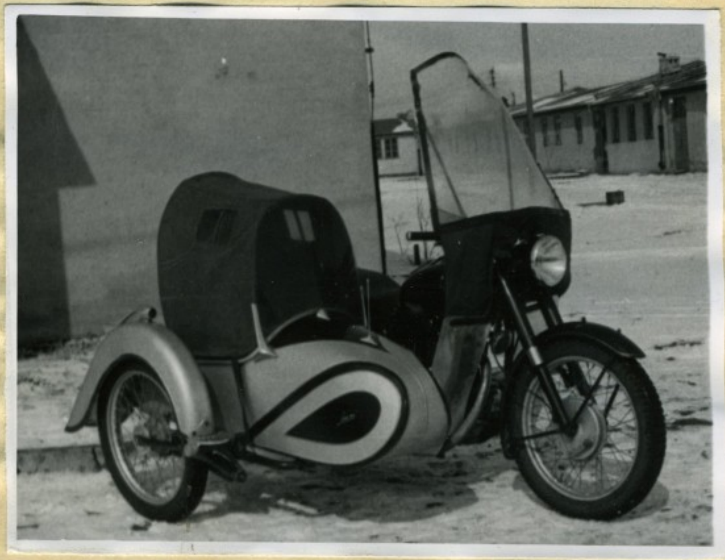
Fot.2 Widok z profilu wózka "SUN" z motocyklem Junak, z zastosowanymi ochronami /koncepcja i wykonanie własne /.
